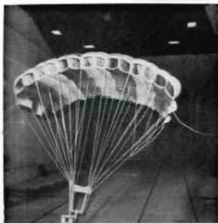
Essais de givrage sur maquette de voile 133 - 11 (Cf. article BERRY... ou Sibérie)
